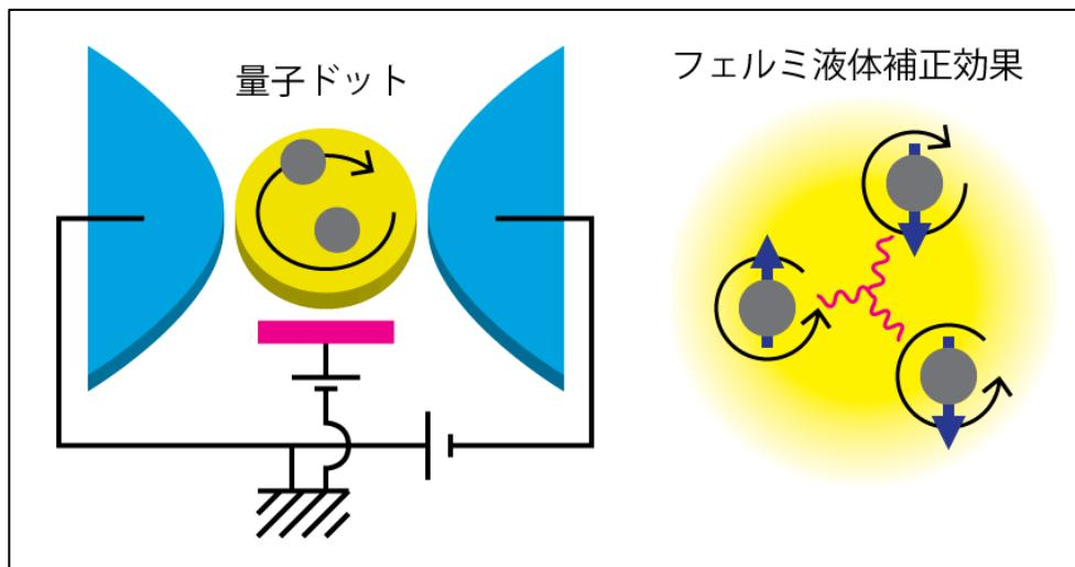
左図: 量子ドット(黄色)とそれに繋がれた 2 つの電子溜り(水色)の概念図。量子ドットに貼り付けられた電極(赤色)で、電子数を制御することができる。また、電子溜り間に電圧を印加することで、電流を駆動し量子ドットの内部の性質を調べることができる。
